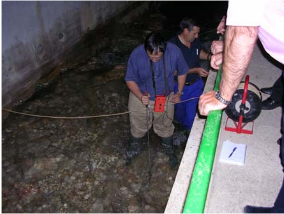
Foto 5 y 6.- Aforo realizado con molinete en julio de 2005. En la foto 6 fuente con vertedero rectangular en la provincia de Alicante.
