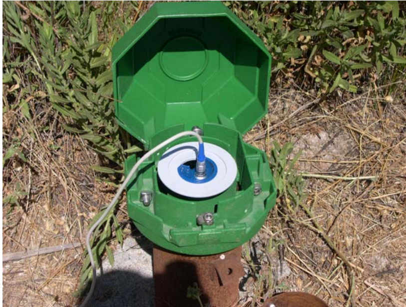
Foto 14.- Piezómetro con la instalación de un sensor de presión (NP y conductividad).
