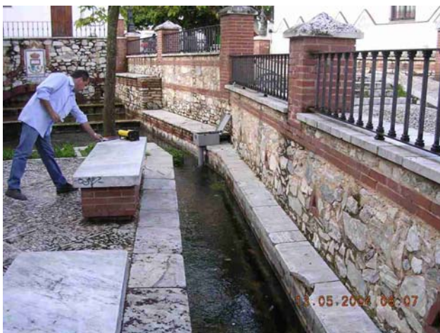
Foto 7 y figura 2. Disposición de un sensor- Thalimedes- en una canal para registrar los caudales circulantes. En la figura anexa se observan el tipo de medidas continuas registradas.
