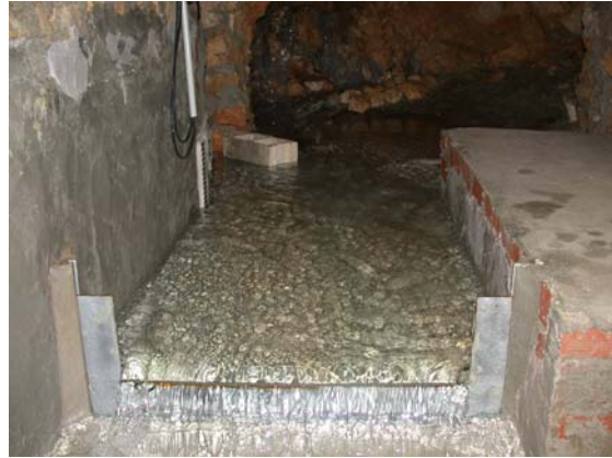
Foto 5 y 6.- Aforo realizado con molinete en julio de 2005. En la foto 6 fuente con vertedero rectangular en la provincia de Alicante.
