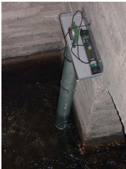
Foto 7 y figura 2. Disposición de un sensor- Thalimedes- en una canal para registrar los caudales circulantes. En la figura anexa se observan el tipo de medidas continuas registradas.
